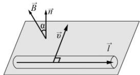
ЭДС индукции в прямом проводнике длиной  $l$ , движущемся со скоростью  $v$
