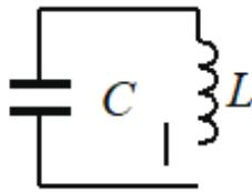
Колебательный контур. Свободные электромагнитные колебания в идеальном колебательном контуре:
